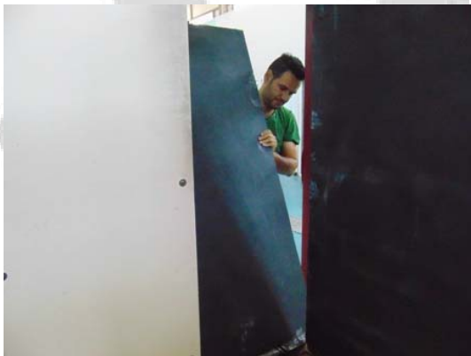
شکل ۲- مراحل نصب آزمون‌های عایق الاستومری Bellsafe Flex در قاب آزمون
