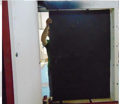
شکل ۲- مراحل نصب آزمون‌های عایق الاستومری Bellsafe Flex در قاب آزمون
