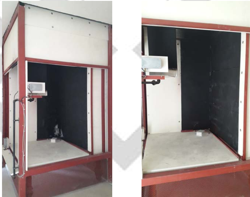
شکل ۳- آزمون عایق الاستومری Bellsafe Flex ، قبل از آزمون (راست) و پس از آن
